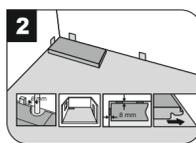
Необходимо соблюдать монтажные деформационные зазоры не менее 8 мм от края покрытия до стен и всех выступающих из основания пола конструкций и элементов. Укладка кварцевого ламината начинается с формирования первого «маякового» ряда. От ровности его монтажа зависит ровность и качество всей укладки.
