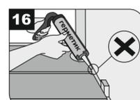
Запрещено заполнять деформационные зазоры строительными смесями.
