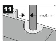
Необходимо соблюдать монтажные деформационные зазоры не менее 8 мм от края покрытия до всех выступающих из основания пола конструкций и элементов (трубы, дверные и оконные рамы, лестницы, колонны, перегородки, пороги, любые крепежные элементы и т. п.).
