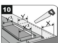
Возможно, придётся обрезать последний ряд – для более качественной укладки измеряйте ширину элемента с двух сторон, учитывая деформационный зазор 8 мм.
