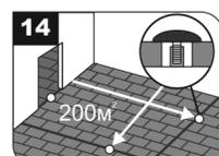
Деформационные зазоры логичнее и проще всего делать в проемах дверей. После укладки кварцевого ламината деформационные зазоры закрываются накладным порогом. Свободный ход покрытия под порогом должен быть не меньше 10 мм.
