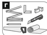
Для укладки кварцевого ламината потребуются линейка, карандаш, пила или элентролобзик, угольник, распорные клинья, нож, плотная подложка толщиной 1,5 мм.
