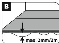
Неровности основания, превышающие 2 мм на 2 м длины укладки, должны быть устранены до начала монтажа кварцевого ламината.
