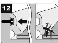
Плинтус крепится к стене. Следите за тем, чтобы плинтус не был жёстко закреплён на поверхности кварцевого ламината — это может привести к деформации покрытия.
